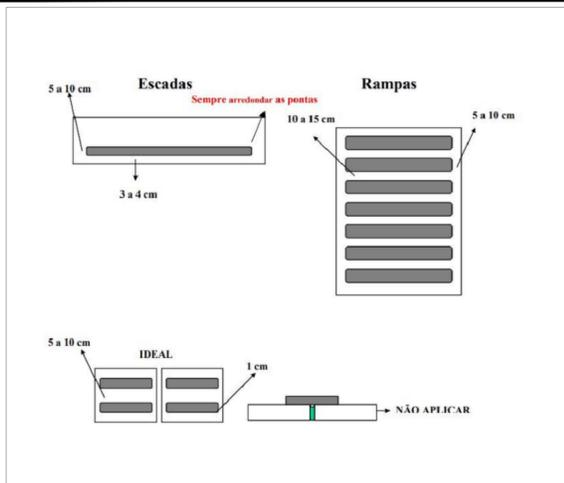
Detalhe fita antiaderente Escala s/e
