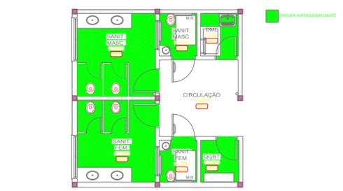
**PLANTA BAIXA DE TALHE PINTURA IMPERMEABILIZANTE** esc. 1:100
